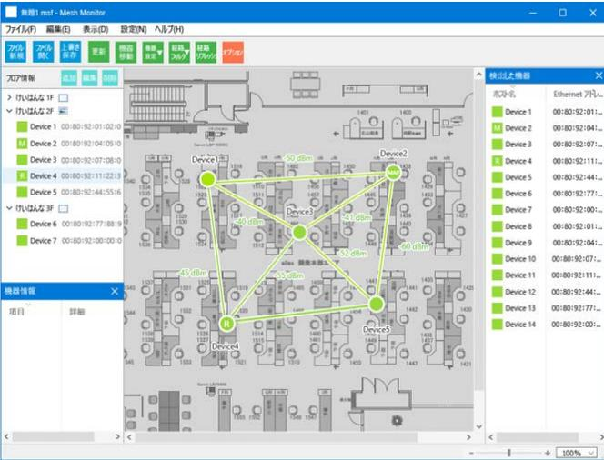
Mesh Monitor ist ein optionales Zusatzmodul zum AMC Manager®, das zur Visualisierung des mit BR-400AN aufgebauten Mesh-Netzwerks dient. Diese Anwendung erleichtert dem Benutzer die Einrichtung und Betriebsverwaltung. Benutzer können den Betriebszustand Ihres Mesh Netzwerkes in Echtzeit bildlich darstellen und Datenübertragungswege, den Zustand der Verbindung zwischen Endgeräten und die Verbindungsqualität auf einen Blick kontrollieren.
